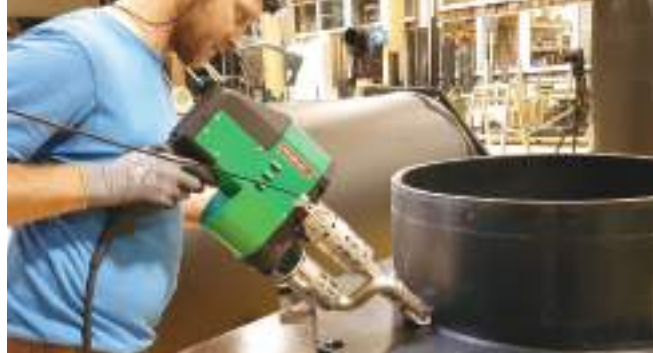
Мощный WELDPLAST S4 в работе
